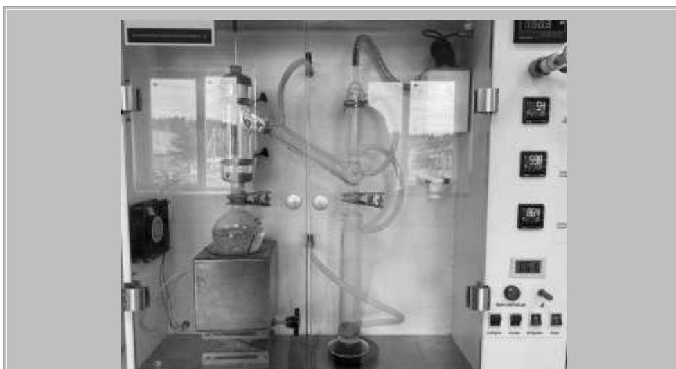
Рис. 1 Лабораторна установка HI-9168 Vacuum Distillation Apparatus
