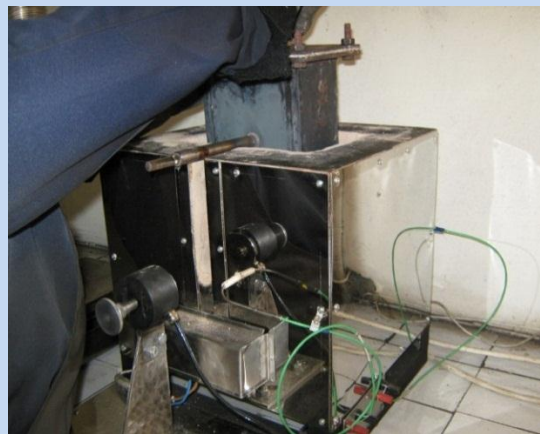
2. Установка реторты в камеру
