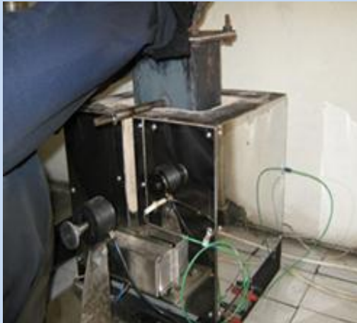
Рис. 3 Установка для определения давления расширения
