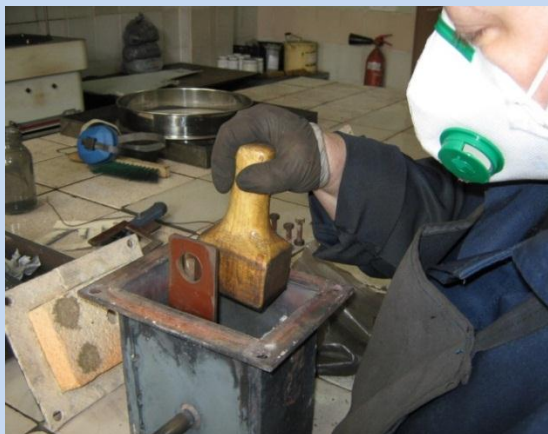
1. Загрузка пробы в реторту
